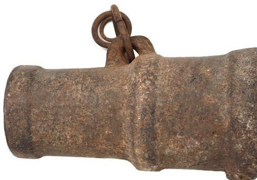
Hlaveň podobného kusu dochovaná bez lafety, ráže 15 cm, průměr prachové komory 5 cm.
